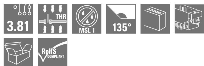
Il connettore maschio SC-SMT resistente alle alte temperature con direzione d'uscita di 135°; l'angolo di 135° viene definito tra la direzione di innesto e il pin brasato e definisce a direzione d'uscita obliqua di 45° rispetto al circuito stampato.
