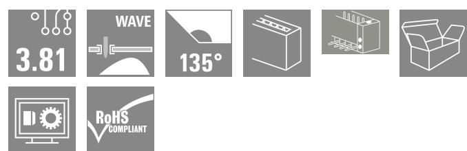
Il connettore maschio SC con direzione d'uscita di 135° - l'angolo di 135° viene definito tra la direzione di innesto e il pin di saldatura e definisce la direzione d'uscita inclinata a 45° rispetto al circuito stampato.
