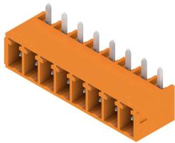
Il connettore maschio SC con direzione d'uscita a 270° - l'angolo di 270° viene definito tra la direzione di innesto e il pin brasato e definisce la direzione di innesto parallela rispetto al circuito stampato, ma per l'innesto dei connettori femmina attraverso la testa.
