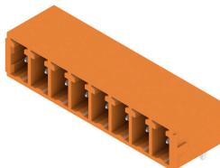
Il connettore maschio SC offre una direzione d'innesto parallela al circuito stampato (orizzontale) ed è disponibile nella variante chiusa (G) e con flangia a vite (F). I connettori Weidmüller nel passo 3,81 mm (0,15 pollici) hanno un layout compatibile con i connettori più diffusi e presentano uno spazio per stampa e codifica, oltre che un supporto per indicatori luminosi.
