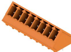
Il connettore maschio SC con direzione d'uscita di 135° - l'angolo di 135° viene definito tra la direzione di innesto e il pin di saldatura e definisce la direzione d'uscita inclinata a 45° rispetto al circuito stampato.
