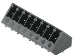
Il connettore maschio SC-SMT resistente alle alte temperature con direzione d'uscita di 135° - l'angolo di 135° viene definito tra la direzione di innesto e il pin brasato e definisce a direzione d'uscita obliqua di 45° rispetto al circuito stampato.
