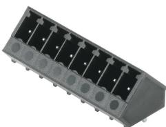
Il connettore maschio SC-SMT resistente alle alte temperature con direzione d'uscita di 135° - l'angolo di 135° viene definito tra la direzione di innesto e il pin brasato e definisce a direzione d'uscita obliqua di 45° rispetto al circuito stampato.
