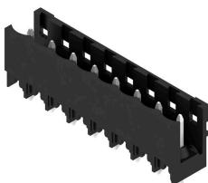
Connettore maschio aperto, diritto, resistente alle alte temperature Imballaggio in scatola o Tape. Su Tape e con codolo a saldare da 1,5 mm, ottimizzati per l'equipaggiamento automatico. Codolo a saldare da 3,2 mm, indicato per saldatura reflow e a onda. Le strisce di connettori maschio presentano uno spazio per la siglatura e sono codificabili. HC = High Current (a corrente forte).
