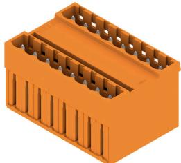
Connettori maschio a due piani con layout d'innesto parallelo. La lunghezza dei codoli a saldare è ottimizzata per saldature ad onda. I connettori presentano uno spazio per la siglatura e possono essere codificati.
