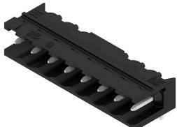
Connettori maschio aperti, angolati a 90°, resistenti alle alte temperature. Imballaggio in scatola o Tape. Su Tape, con codolo a saldare da 1,5 mm, ottimizzati per l'equipaggiamento automatico. Codolo a saldare da 3,2 mm, indicato per saldatura reflow e a onda. Le strisce di connettori maschio presentano uno spazio per la siglatura e sono codificabili. HC = High Current (a corrente forte).
