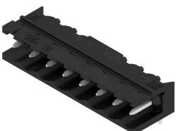
Connettore maschio aperti, angolati a 90°, resistenti alle alte temperature. Imballaggio in scatola o Tape. Su Tape, con codolo a saldare da 1,5 mm, ottimizzati per l'equipaggiamento automatico. Codolo a saldare da 3,2 mm, indicato per saldatura reflow e a onda. Le strisce di connettori maschio presentano uno spazio per la siglatura e sono codificabili. HC = High Current (a corrente forte).
