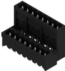
Connettore maschio chiuso, resistente alle alte temperature, su due piani, sfalsato lateralmente, con flangia a saldare opzionale. Codolo a saldare 1,5 mm, adatto a saldatura Reflow. Codolo di 3,2 mm adatto a saldature ad onda e Reflow. I connettori presentano uno spazio per la siglatura e possono essere codificati.
