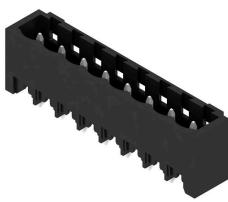
Striscia di connettori maschio resistenti alle alte temperature, in confezione Box o Tape. Su Tape, con codolo a saldare da 1,5 mm, ottimizzati per l'equipaggiamento automatico. Codolo a saldare da 3,2 mm, indicato per saldatura reflow e a onda. Le strisce di connettori maschio presentano uno spazio per la siglatura e sono codificabili. HC = High Current (a corrente forte).
