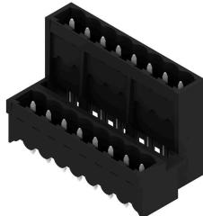
Connettore maschio chiuso, resistente alle alte temperature, su due piani, sfalsato lateralmente, con flangia a saldare opzionale. Codolo a saldare 1,5 mm, adatto a saldatura Reflow. Codolo di 3,2 mm adatto a saldature ad onda e Reflow. I connettori presentano uno spazio per la siglatura e possono essere codificati.
