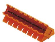
Connettori maschio con direzione d#92 uscita a 135°. La lunghezza dei codoli a saldare è ottimizzata per saldature ad onda. I connettori presentano uno spazio per la siglatura e possono essere codificati.
