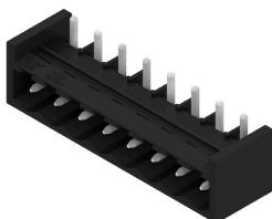
Connettore maschio aperto, diritto, resistente alle alte temperature Imballaggio in scatola o Tape. Su Tape e con codolo a saldare da 1,5 mm, ottimizzati per l'equipaggiamento automatico. Codolo a saldare da 3,2 mm, indicato per saldatura reflow e a onda. Le strisce di connettori maschio presentano uno spazio per la siglatura e sono codificabili. HC = High Current (a corrente forte).
