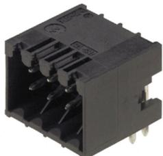
Connettori maschio dritti, a due file, resistenti alle alte temperature, idonei a tutti i processi di saldatura più diffusi. Ottimizzati per l'equipaggiamento automatico. Confezione Box o Tape. Codolo di 3,2 mm adatto a saldature ad onda e Reflow. I connettori maschio presentano un'area per la siglatura e possono essere codificati
