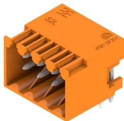
Connettori maschio angolati a due file nelle versioni con chiusura laterale o con flangia (connettori maschio aperti lateralmente disponibili a richiesta). I connettori maschio da 3,5 mm sono idonei alla saldatura ad onda e sono forniti in una scatola. È possibile un avvvitamento sul circuito stampato. I connettori presentano uno spazio per la siglatura e possono essere codificati.
