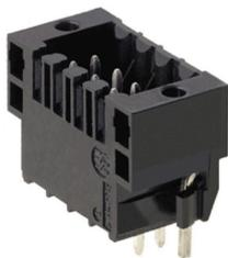
Striscia di connettori maschio a due file, resistente alle alte temperature per tutte le tecniche di saldatura tradizionali. Ottimizzati per l'equipaggiamento automatico. Imballaggio in scatola o Tape. Codolo a saldare da 3,2 mm, indicato per saldatura reflow e a onda. I connettori maschio dispongono di spazio per la siglatura e sono codificabili.
