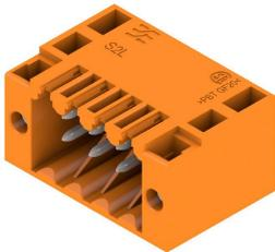
Connettori maschio angolati a due file nelle versioni con chiusura laterale o con flangia (connettori maschio aperti lateralmente disponibili a richiesta). I connettori maschio da 3,5 mm sono idonei alla saldatura ad onda e sono forniti in una scatola. È possibile un avvvitamento sul circuito stampato. I connettori presentano uno spazio per la siglatura e possono essere codificati.
