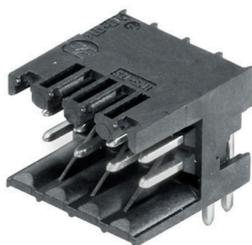
Connettori maschio dritti, a due file, resistenti alle alte temperature, idonei a tutti i processi di saldatura più diffusi. Ottimizzati per l'equipaggiamento automatico. Confezione Box o Tape. Codolo di 3,2 mm adatto a saldature ad onda e Reflow. I connettori maschio presentano un'area per la siglatura e possono essere codificati (imballaggio Tape a richiesta)
