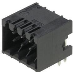
Connettori maschio diritti, a due file, resistenti alle alte temperature, idonei a tutti i processi di saldatura più diffusi. Ottimizzati per l'equipaggiamento automatico. Confezione Box o Tape. Codolo di 3,2 mm adatto a saldature ad onda e Reflow. I connettori maschio presentano un'area per la siglatura e possono essere codificati
