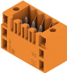
Striscia di connettori con codolo dritti a due file disponibile nelle versioni con chiusura laterale o con flangia (connettori con codolo aperti lateralmente disponibili a richiesta). I connettori maschio con lunghezza codolo da 3,5 mm sono progettati per la saldatura ad onda e sono imballati in scatole di cartone. Possono essere avvitati sul circuito stampato. Le strisce di connettori maschio presentano uno spazio per la siglatura e sono codificabili.
