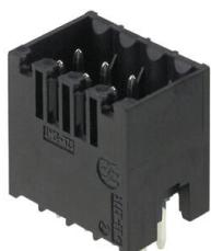
Striscia di connettori maschio a due file, resistente alle alte temperature per tutte le tecniche di saldatura tradizionali. Ottimizzati per l'equipaggiamento automatico. Imballaggio in scatola o Tape. Codolo a saldare da 3,2 mm, indicato per saldatura reflow e a onda. I connettori maschio dispongono di spazio per la siglatura e sono codificabili.
