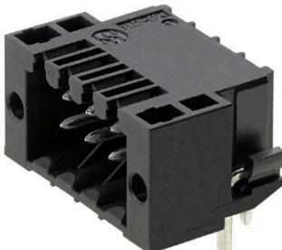
Connettori maschio diritti, a due file, resistenti alle alte temperature, idonei a tutti i processi di saldatura più diffusi. Ottimizzati per l'equipaggiamento automatico. Confezione Box o Tape. Codolo di 3,2 mm adatto a saldature ad onda e Reflow. I connettori maschio presentano un'area per la siglatura e possono essere codificati
