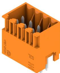
Striscia di connettori con codolo dritti a due file disponibile nelle versioni con chiusura laterale o con flangia (connettori con codolo aperti lateralmente disponibili a richiesta). I connettori maschio con lunghezza codolo da 3,5 mm sono progettati per la saldatura ad onda e sono imballati in scatole di cartone. Possono essere avvitati sul circuito stampato. Le strisce di connettori maschio presentano uno spazio per la siglatura e sono codificabili.
