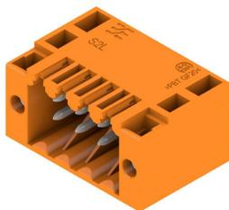
Connettori maschio angolati a due file nelle versioni con chiusura laterale o con flangia (connettori maschio aperti lateralmente disponibili a richiesta). I connettori maschio da 3,5 mm sono ideali per la saldatura ad onda e sono forniti in una scatola. È possibile un avvitamento sul circuito stampato. I connettori presentano uno spazio per la siglatura e possono essere codificati.
