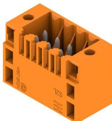
Striscia di connettori con codolo dritti a due file disponibile nelle versioni con chiusura laterale o con flangia (connettori con codolo aperti lateralmente disponibili a richiesta). I connettori maschio con lunghezza codolo da 3,5 mm sono progettati per la saldatura ad onda e sono imballati in scatole di cartone. Possono essere avvitati sul circuito stampato. Le strisce di connettori maschio presentano uno spazio per la siglatura e sono codificabili.
