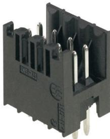
Striscia di connettori maschio a due file, resistente alle alte temperature per tutte le tecniche di saldatura tradizionali. Ottimizzati per l'equipaggiamento automatico. Imballaggio in scatola o Tape. Codolo a saldare da 3,2 mm, indicato per saldatura reflow e a onda. I connettori maschio dispongono di spazio per la siglatura e sono codificabili.
