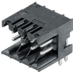
Connettori maschio dritti, a due file, resistenti alle alte temperature, idonei a tutti i processi di saldatura più diffusi. Ottimizzati per l'equipaggiamento automatico. Confezione Box o Tape. Codolo di 3,2 mm adatto a saldature ad onda e Reflow. I connettori maschio presentano un'area per la siglatura e possono essere codificati (imballaggio Tape a richiesta)
