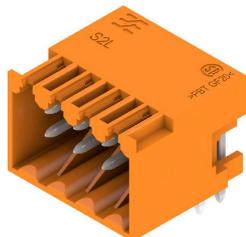
Connettori maschio angolati a due file nelle versioni con chiusura laterale o con flangia (connettori maschio aperti lateralmente disponibili a richiesta). I connettori maschio da 3,5 mm sono ideali alla saldatura ad onda e sono forniti in una scatola. È possibile un avvvitamento sul circuito stampato. I connettori presentano uno spazio per la siglatura e possono essere codificati.
