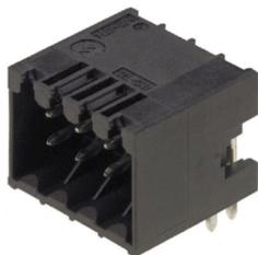
Connettori maschio dritti, a due file, resistenti alle alte temperature, idonei a tutti i processi di saldatura più diffusi. Ottimizzati per l'equipaggiamento automatico. Confezione Box o Tape. Codolo di 3,2 mm adatto a saldature ad onda e Reflow. I connettori maschio presentano un'area per la siglatura e possono essere codificati
