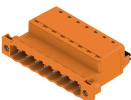
Connettore maschio con tecnica di collegamento PUSH IN con direzione di uscita diritta, insieme a BLF 5.08HC come applicazione Wire-to-Wire come passaggio a parete. I connettori maschio presentano uno spazio per la siglatura e possono essere codificati.
