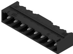
Striscia di connettori maschio resistenti alle alte temperature, in confezione Box o Tape. Su Tape, con codolo a saldare da 1,5 mm, ottimizzati per l'equipaggiamento automatico. Codolo a saldare da 3,2 mm, indicato per saldatura reflow e a onda. Le strisce di connettori maschio presentano uno spazio per la siglatura e sono codificabili. HC = High Current (a corrente forte).
