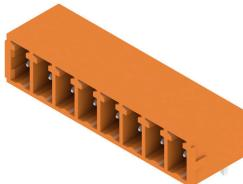
Il connettore maschio SC offre una direzione d'innesto parallela al circuito stampato (orizzontale) ed è disponibile nella variante chiusa (G) e con flangia a vite (F). I connettori Weidmüller nel passo 3,81 mm (0,15 pollici) hanno un layout compatibile con i connettori più diffusi e presentano uno spazio per stampa e codifica, oltre che un supporto per indicatori luminosi.
