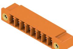
Il connettore maschio SC offre una direzione d'innesto parallela al circuito stampato (orizzontale) ed è disponibile nella variante chiusa (G) e con flangia a vite (F). I connettori Weidmüller nel passo 3,81 mm (0,15 pollici) hanno un layout compatibile con i connettori più diffusi e presentano uno spazio per stampa e codifica, oltre che un supporto per indicatori luminosi.
