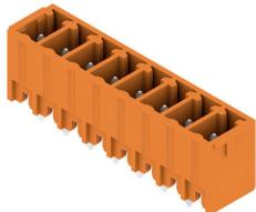
Il connettore maschio SC offre una direzione d'innesto perpendicolare rispetto al circuito stampato (verticale) ed è disponibile nella variante chiusa (G) e con flangia a vite (F). I connettori Weidmüller nel passo 3,81 mm (0,15 pollici) hanno un layout compatibile con i connettori più diffusi e presentano uno spazio per siglatura e codifica.
