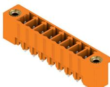
Il connettore maschio SC offre una direzione d'innesto perpendicolare rispetto al circuito stampato (verticale) ed è disponibile nella variante chiusa (G) e con flangia a vite (F). I connettori Weidmüller nel passo 3,81 mm (0,15 pollici) hanno un layout compatibile con i connettori più diffusi e presentano uno spazio per siglatura e codifica.
