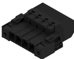
Striscia di connettori maschio inversi a 180° con tecnologia di collegamento PUSH IN per il cablaggio in campo da 6 mm<sup>2</sup> nel passo 7,62 come "variante a tre flange" del passaggio nella custodia. Ideale per custodie con spessore max. di parete 2 mm. Ideale anche come soluzione di protezione contro i contatti accidentali per le tensioni inverse. Soddisfa i requisiti delle norme UL1059 600 V classe C e IEC 61800-5-1.
