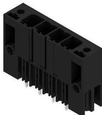
Striscia di connettori maschio su una fila, ad alte prestazioni, affiancabili senza perdita di poli o con flangia brevettata per un fissaggio rapido, senza utensili. Massima affidabilità di collegamento e funzionamento grazie ad un contropunto che impedisce errori di collegamento, con diversità di codifica univoca e fissaggio supplementare nella flangia. Lunghezza codolo 3,5 mm ottimizzato per saldatura ad onda senza piombo.
