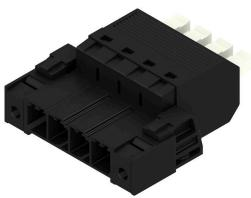
Connettore maschio inverso a 180° con tecnologia di collegamento PUSH IN e attuatore regolabile per il cablaggio sul campo da 6 mm<sup>2</sup> con passo 7,62. Ideale anche come soluzione di protezione contro i contatti accidentali per le tensioni inverse. Soddisfa i requisiti delle norme UL1059 600 V classe C e IEC 61800-5-1. Varianti: senza flangia, flangia esterna, flangia centrale con meccanismo bloccabile e fissaggio a vite aggiuntivo opzionale.
