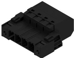
Striscia di connettori maschio inversi a 180° con tecnologia di collegamento PUSH IN per il cablaggio in campo da 6 mm<sup>2</sup> nel passo 7,62 come "variante a tre flange" del passaggio nella custodia. Ideale per custodie con spessore max. di parete 2 mm. Ideale anche come soluzione di protezione contro i contatti accidentali per le tensioni inverse. Soddisfa i requisiti delle norme UL1059 600 V classe C e IEC 61800-5-1.
