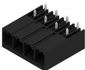
Connettori maschio ad alte prestazioni per correnti forti su una fila, affiancabili senza perdita di poli o con flangia per un rapido fissaggio senza utensili. Massima affidabilità di collegamento e funzionamento grazie ad un controprofilo che impedisce errori di collegamento, con diversità di codifica univoca e fissaggio supplementare nella flangia.
