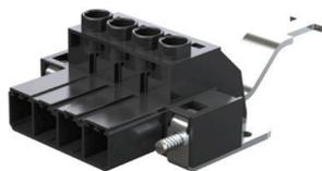
Striscia di connettori maschio ad alte prestazioni con la collaudata staffa di serraggio Weidmüller in acciaio inox, senza manutenzione al 100%. Affiancabili senza perdita di poli o con flangia multifunzione brevettata per un bloccaggio sicuro, veloce e senza utensili. Massima affidabilità di collegamento e funzionamento grazie al controprofilo che impedisce errori di collegamento, con diversità di codifica univoca, protezione da errori di cablaggio. Siglabile.
