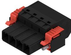
Striscia di connettori maschio inversi con tecnologia di collegamento PUSH IN per il cablaggio in campo con flange esterne inverse da 6 mm<sup>2</sup> con passo 7,62. Ideale anche come soluzione di protezione contro i contatti accidentali per le tensioni inverse. Soddisfa i requisiti delle norme UL1059 600 V classe C e IEC 61800-5-1. Disponibile opzionalmente anche nella versione avvitabile e senza flangia.
