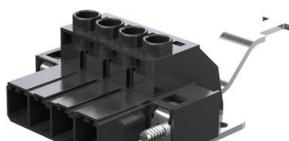
Striscia di connettori maschio ad alte prestazioni con la collaudata staffa di serraggio Weidmüller in acciaio inox, senza manutenzione al 100%. Affiancabili senza perdita di poli o con flangia multifunzione brevettata per un bloccaggio sicuro, veloce e senza utensili. Massima affidabilità di collegamento e funzionamento grazie al contropunto che impedisce errori di collegamento, con diversità di codifica univoca, protezione da errori di cablaggio. Siglabile.
