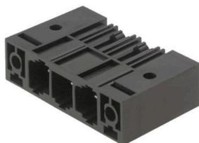
Striscia di connettori maschio su una fila, ad alte prestazioni, affiancabili senza perdita di poli o con flangia brevettata per un fissaggio rapido, senza utensili. Massima affidabilità di collegamento e funzionamento grazie ad un controprofilo che impedisce errori di collegamento, con diversità di codifica univoca e fissaggio supplementare nella flangia. Lunghezza codolo di 3,5 mm ottimizzata per saldatura ad onda, direzione d'innesto a 270° rispetto ai codoli a saldare.
