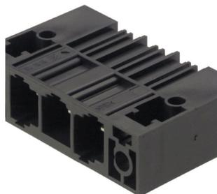
Striscia di connettori maschio su una fila, per correnti forti, affiancabili senza perdita di poli o con flangia brevettata per un bloccaggio rapido, senza utensili. Massima affidabilità di collegamento e funzionamento grazie ad un controprofilo che impedisce errori di collegamento, con diversità di codifica univoca e fissaggio supplementare nella flangia. Lunghezza codolo di 3,5 mm ottimizzata per saldatura ad onda, direzione d'innesto a 90° rispetto ai codoli a saldare.
