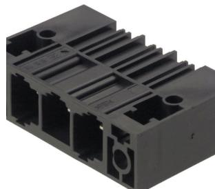
Striscia di connettori maschio su una fila, per correnti forti, affiancabili senza perdita di poli o con flangia brevettata per un bloccaggio rapido, senza utensili. Massima affidabilità di collegamento e funzionamento grazie ad un controprofilo che impedisce errori di collegamento, con diversità di codifica univoca e fissaggio supplementare nella flangia. Lunghezza codolo di 3,5 mm ottimizzata per saldatura ad onda, direzione d'innesto a 90° rispetto ai codoli a saldare.
