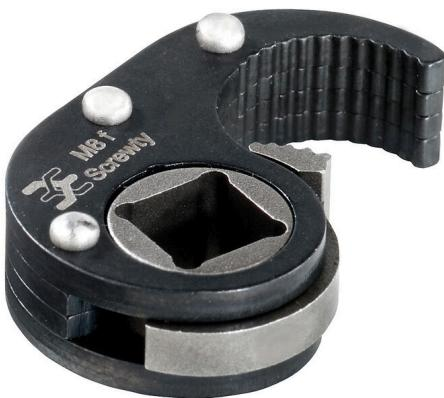
L'utensile di fissaggio Screwty® è indicato per connettori circolari M12 confezionabili liberamente con dimensioni esterne della rondella zigrinata pari a  $11,9 \pm 0,3$  mm. La coppia di serraggio è pari a 0,5-0,6 Nm.
