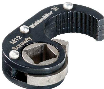
L'utensile di fissaggio Screwty® è indicato per connettori circolari M12 con dimensioni esterne della rondella zig-zag pari a  $14,5 \pm 0,3$  mm. La coppia di serraggio è pari a 0,8-1,2 Nm.
