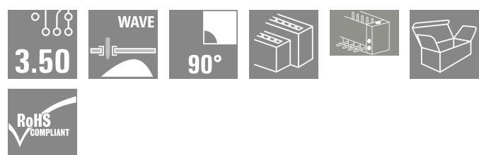
Striscia di connettori maschio stratificati su due livelli per saldatura a onda in passo 3,50 mm. Disponibili in versione chiusa e con flangia. I connettori maschio dispongono di spazio per la siglatura e sono codificabili.
