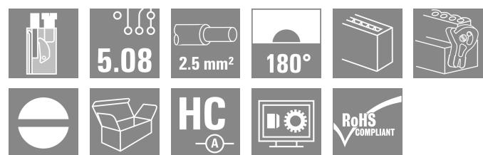
Connettori femmina con collegamento a vite in tecnica TOP per il collegamento di fili con conduttore dritto e meccanismo a barretta di sgancio. I connettori femmina dispongono di uno spazio per la siglatura e sono codificati. HC = High Current (a corrente forte).
