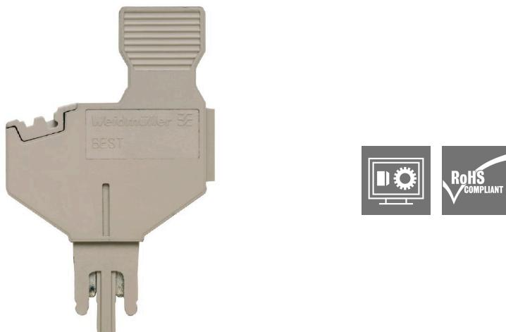
La spina per componenti viene utilizzata per integrare un componente elettronico in una morsettiera di sezionamento. Dopo aver saldato il componente elettronico, la spina può essere integrata nell'area di disconnessione dei nostri morsetti sezionatori e quindi cambia il morsetto sezionatore in un morsetto modulare con componente elettronico integrato.
