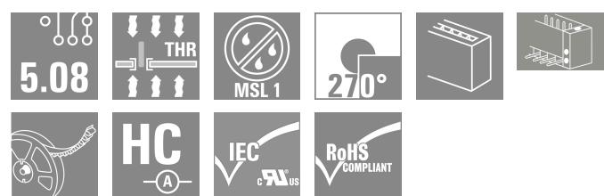
Connettore maschio aperto, diritto, resistente alle alte temperature Imballaggio in scatola o Tape. Su Tape e con codolo a saldare da 1,5 mm, ottimizzati per l'equipaggiamento automatico. Codolo a saldare da 3,2 mm, indicato per saldatura reflow e a onda. Le strisce di connettori maschio presentano uno spazio per la siglatura e sono codificabili. HC = High Current (a corrente forte).
