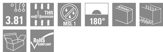
Connettore maschio resistente alle alte temperature (SC-SMT 180G) nel passo 3,81 mm (0,15 pollici)
