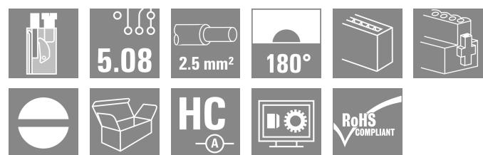
Connettori femmina con collegamento a vite in tecnica TOP per il collegamento di cavi con conduttore dritto e flangia a vite. I connettori femmina dispongono di uno spazio per la siglatura e sono codificabili. HC = High Current (a corrente forte).
