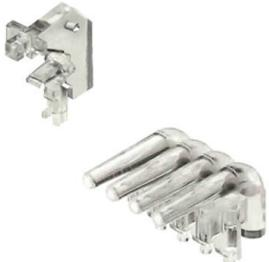
Efficace: il collegamento tra il LED e il pannello anteriore. Gli indicatori luminosi permettono agli utenti di monitorare gli stati di commutazione senza che sia necessario un design speciale: la plastica ottica dirige la luce dai LED standard intorno a una curva nei connettori o attraverso la piastra anteriore.
