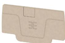
Le piastre terminali sono fissate sul lato aperto dell'ultimo morsetto componibile prima del terminale di fissaggio. Inserendo la piastra terminale viene mantenuta la funzione del morsetto così come la tensione di dimensionamento indicata. È garantita una protezione contro parti sotto tensione e il morsetto terminale è sicuro per le dita.
