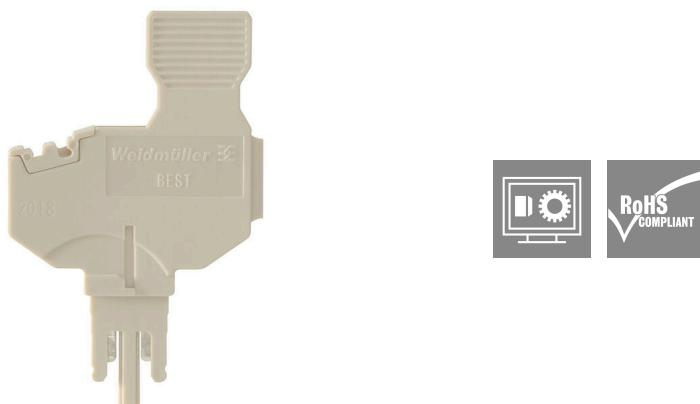
La spina per componenti viene utilizzata per integrare un componente elettronico in una morsettiera di sezionamento. Dopo aver saldato il componente elettronico, la spina può essere integrata nell'area di disconnessione dei nostri morsetti sezionatori e quindi cambia il morsetto sezionatore in un morsetto modulare con componente elettronico integrato.
