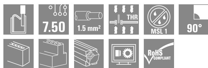
Morsetto per circuito stampato per equipaggiamento completamente automatico con saldatura reflow (SMT) e tecnica PUSH IN di collegamento del conduttore. Inserimento del conduttore e azionamento del cursore nella stessa direzione (TOP). Imballaggio in scatola o come Tape-on-Reel. Lunghezza dei pin ottimizzata a 1,5 mm o 3,5 mm.
