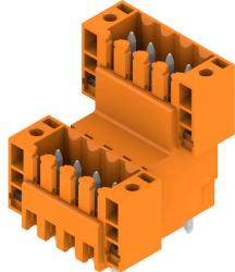
Striscia di connettori maschio stratificati su due livelli per saldatura a onda in passo 3,50 mm. Disponibili in versione chiusa e con flangia. I connettori maschio dispongono di spazio per la sigillatura e sono codificabili.
