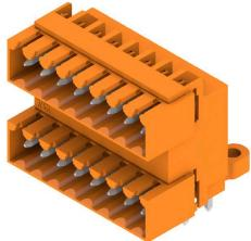
Connettori maschio su due file per saldatura ad onda nel passo 3,50 mm. Il giunto è disponibile in versione aperta, chiusa e con flangia. I connettori maschio dispongono di spazio per la sigillatura e sono codificabili. Imballaggio in scatole di cartone.
