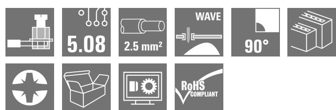
Morsetto per circuito stampato a 1 fila a forma alta e bassa, con collaudato collegamento a staffa di serraggio nel passo 5,08 mm e direzione d'uscita del conduttore a 90°. Adatto per sezioni del cavo fino a 2,5 mm<sup>2</sup>.
