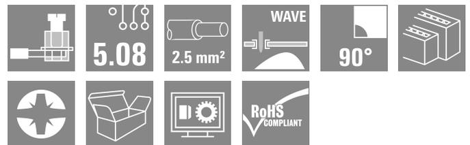
Morsetto per circuito stampato a 1 fila a forma alta e bassa, con collaudato collegamento a staffa di serraggio nel passo 5,08 mm e direzione d'uscita del conduttore a 90°. Adatto per sezioni del cavo fino a 2,5 mm<sup>2</sup>.
