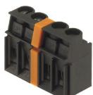
La tensione massima si basa sulla distanza minima. Le piastre intermedie aumentano le distanze di dispersione e di isolamento tra i diversi potenziali e consentono tensioni nominali più elevate o una netta separazione, ad esempio tra la rete elettrica e le tensioni basse o le diverse zone di protezione.
