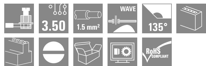
Morsetto per circuito stampato piccolo e compatto con collaudato collegamento a staffa di serraggio nel passo 3,5 mm. Direzione d'uscita del conduttore a 90° e 135°. Adatto per sezioni del cavo fino a 1,5 mm<sup>2</sup>.
