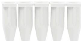
L'impiego di manicotti di riduzione semplifica il collegamento dei conduttori nelle sezioni più piccole. I conduttori possono essere inseriti nel punto di serraggio in modo sicuro, senza danneggiare i trefoli. Con il manico di riduzione, il conduttore viene centrato nel punto di serraqqio.
