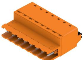
Connettore maschio con tecnica di collegamento PUSH IN con direzione di uscita diritta, insieme a BLF 5.08HC come applicazione Wire-to-Wire come passaggio a parete. I connettori maschio presentano uno spazio per la siglatura e possono essere codificati.
