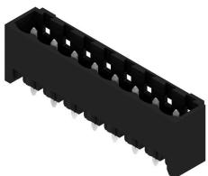
Striscia di connettori maschio resistenti alle alte temperature, in confezione Box o Tape. Su Tape, con codolo a saldare da 1,5 mm, ottimizzati per l'equipaggiamento automatico. Codolo a saldare da 3,2 mm, indicato per saldatura reflow e a onda. Le strisce di connettori maschio presentano uno spazio per la siglatura e sono codificabili. HC = High Current (a corrente forte).
